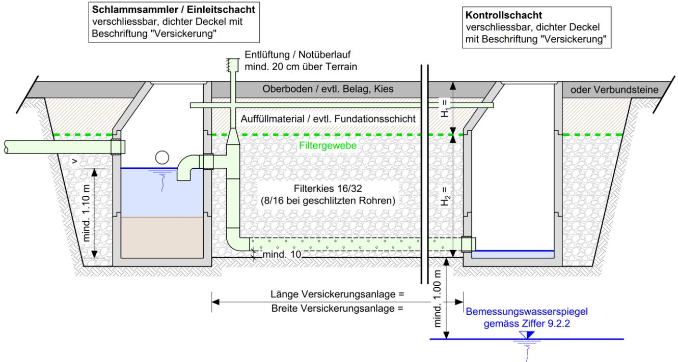
Typ 3c: Kombinierte Anlage Schacht - Strang
